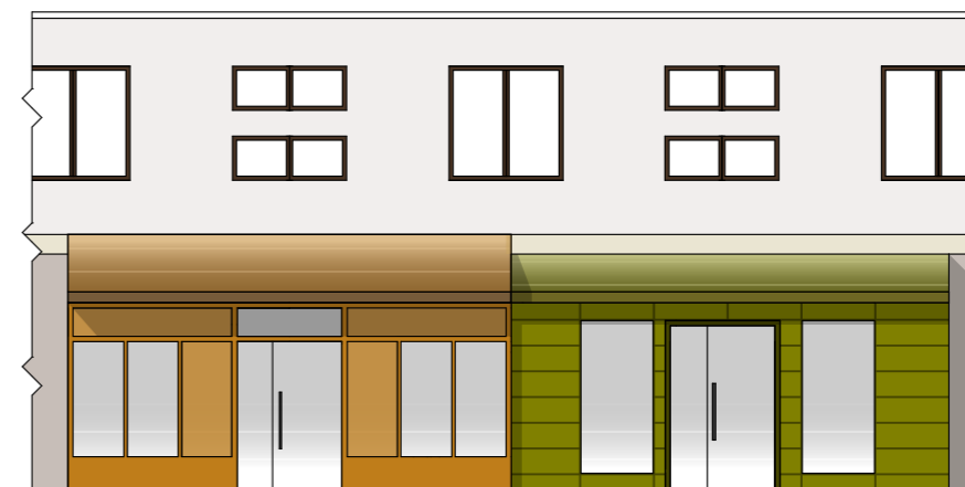
Пристройки в рамках одного не сочетаются между собой и не соответствуют архитектурному решению фасада здания
