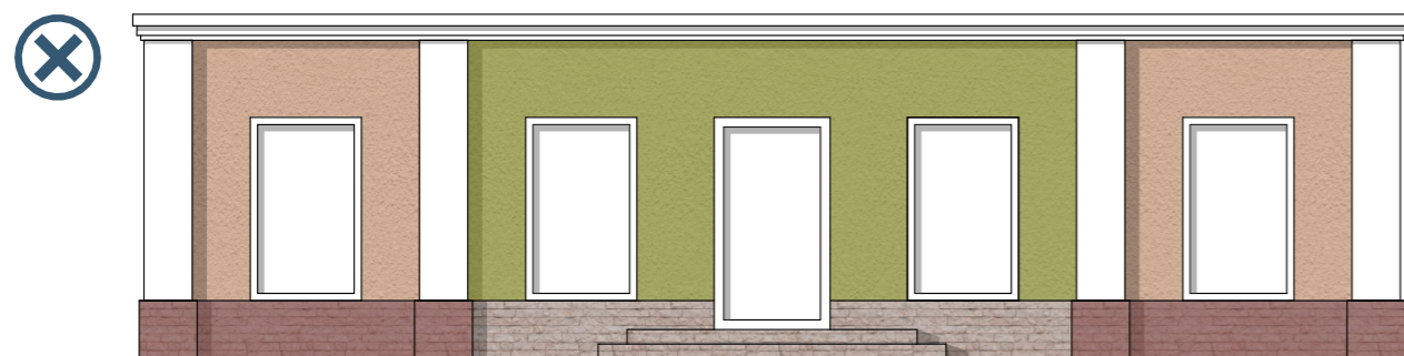
Фасад, выполненный из ценных материалов, фрагментарно окрашен
