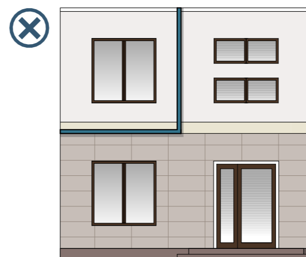
Инженерные провода расположены в коробе, контрастирующим с цветом фасада
