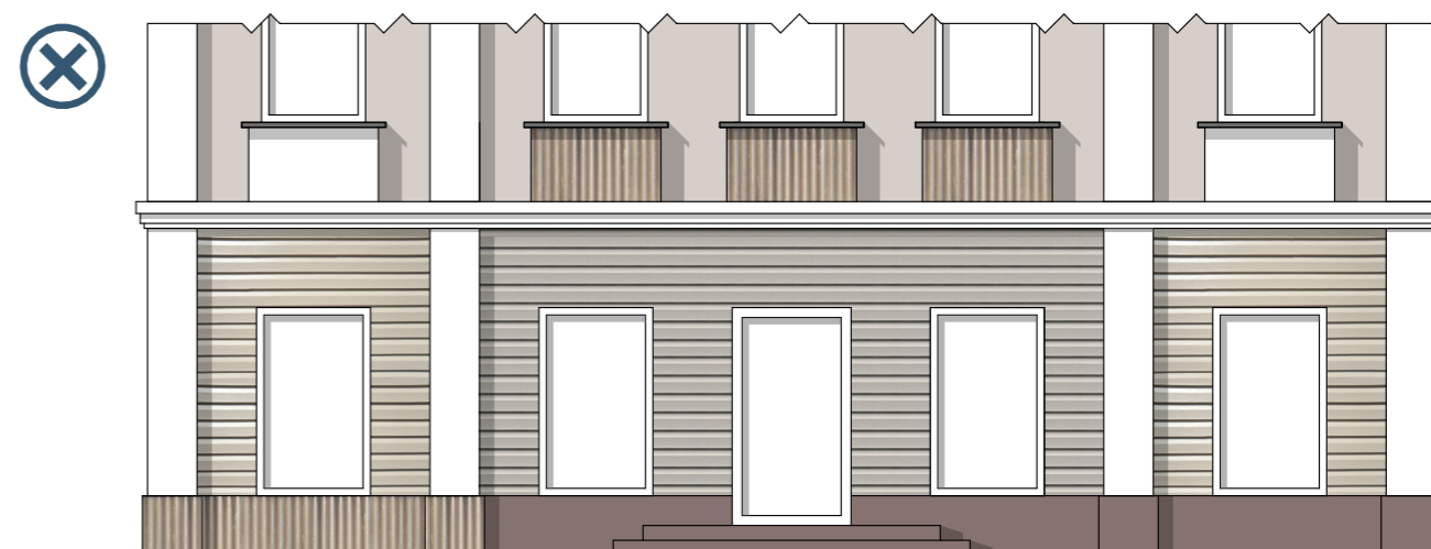
Отделка фасада нарушена применением сайдинга и профилированного листа
