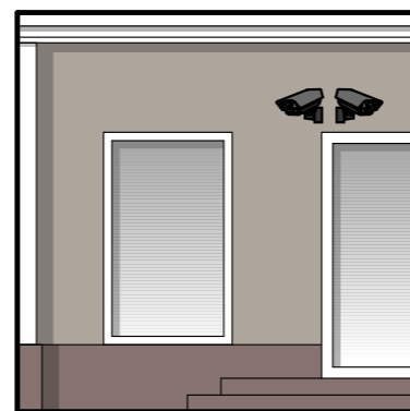
Видеокамера расположена на чистой поверхности фасада
