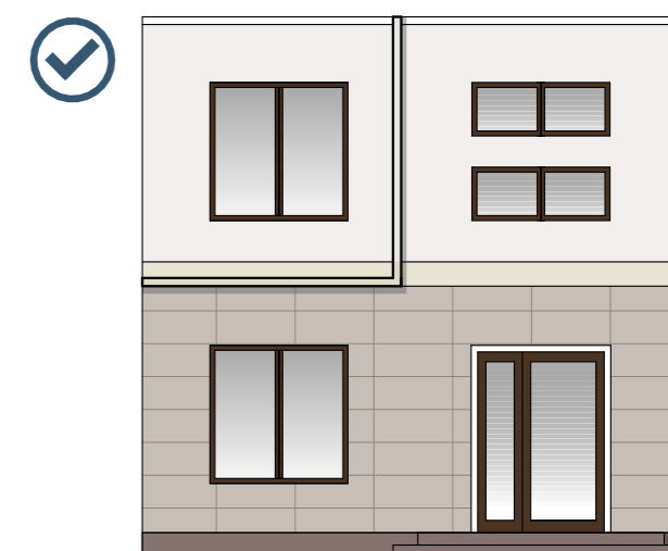
Инженерные провода расположены в коробе, окрашенном в цвет фасада
