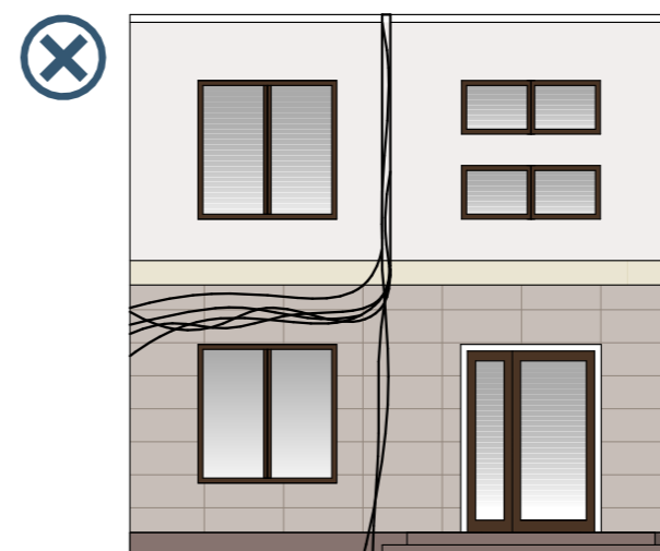
Инженерные провода расположены хаотично
