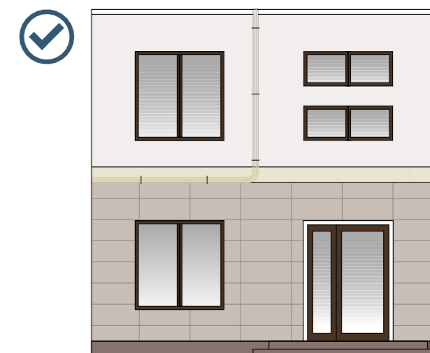
Инженерные провода расположены упорядоченно и окрашены в цвет фасада
