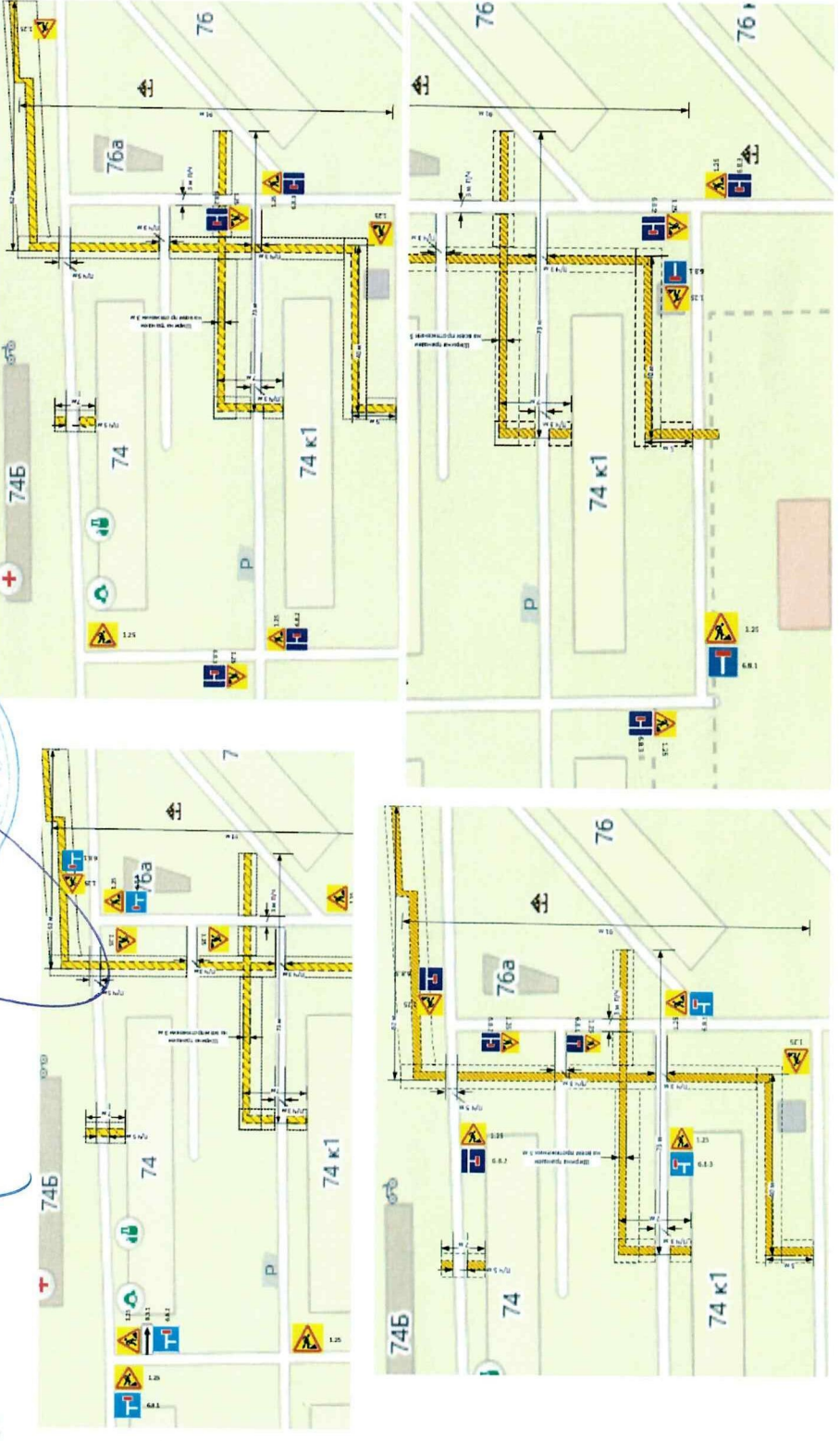
Схема расположения технических средств организации дорожного движения на время проведения ремонтных работ.
