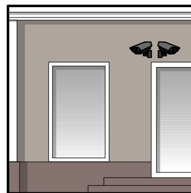
Видеокамера расположена на чистой поверхности фасада
