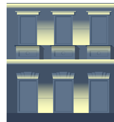
Комбинированная архитектурная подсветка
