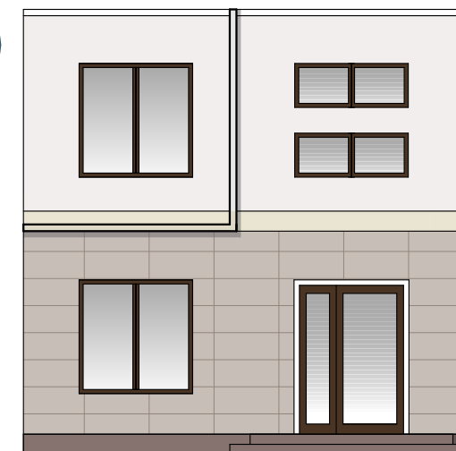
Инженерные провода расположены в коробе, окрашенном в цвет фасада
